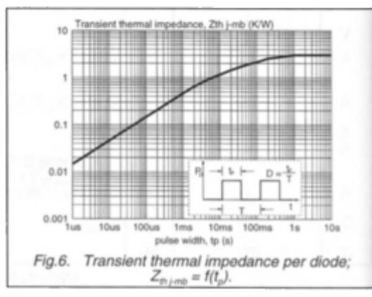
Fig.6. Transient thermal impedance per diode;
